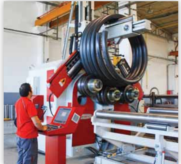
• APK 244 hidrolik 4 toplu profil bükme makinesi (özel üretim) / 4 rolls hydraulic profile bending machines (special products)
